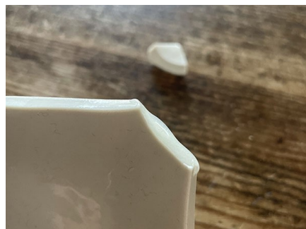
③混ぜたボンドを、割れ目に塗る。 はみ出ても気にせずたっぷりとのせる。
